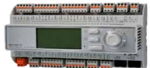
Il software standard del regolatore POL638 è stato personalizzato per gestire i segnali di comando dei sistemi Daikin ERQ e VRV IV.
